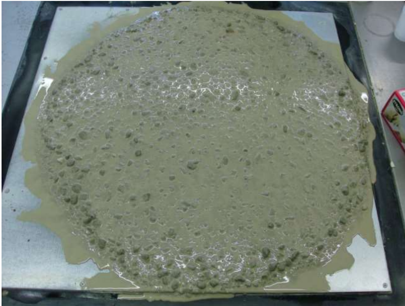
Concreto sem estabilizador
